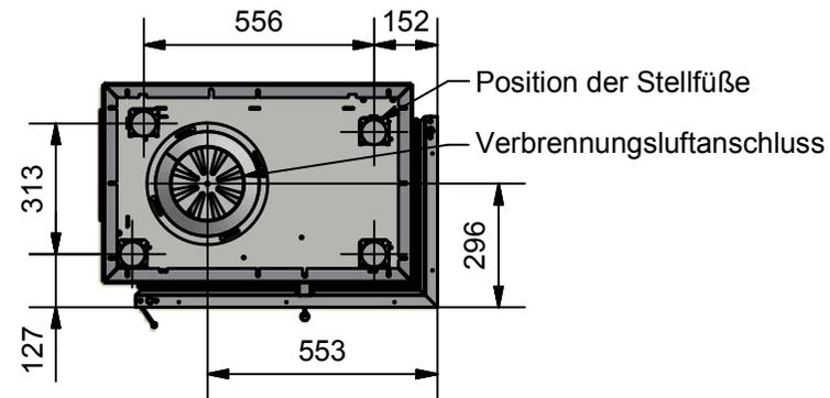
Alle Höhenangaben gelten bei einer Mörtelfugenstärke von 3 mm, einer Fasermattenstärke von 3 mm (im zusammengepressten Zustand) und vollständig nach unten geschraubtem Grundgestell.
